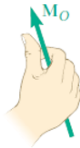
شکل 7: جهت لنگر نیرو حول یک نقطه
